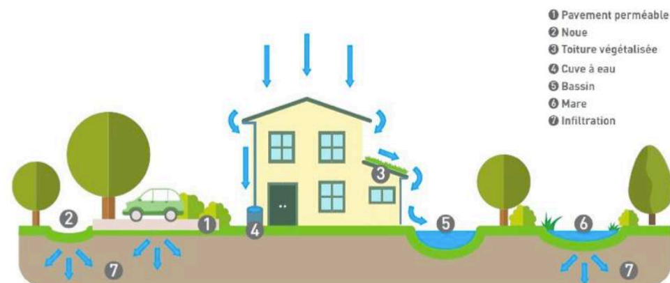
Figure 19: Aménagement pour la gestion des eaux pluviales à la parcelle : exemple 1
